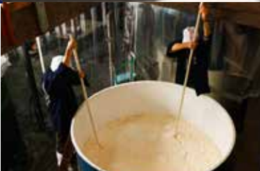
酵母を培養した酒母と麹、蒸米、仕込み水を合わせたモロミは、搾り入れで温度管理やガス抜きを行う。
